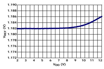
FIGURE 4. V<sub>REF</sub> vs SUPPLY VOLTAGE
