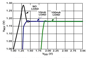
FIGURE 7. DROPOUT - V<sub>REF</sub> OUTPUT
