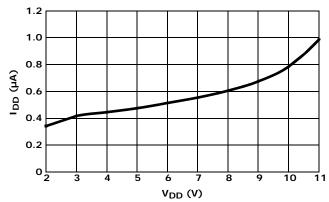
FIGURE 2. I<sub>DD</sub> vs V<sub>DD</sub>
